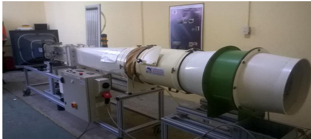
Túnel de viento utilizado para la prueba experimental
